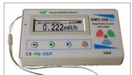
Modern digital-readout Geiger counter
